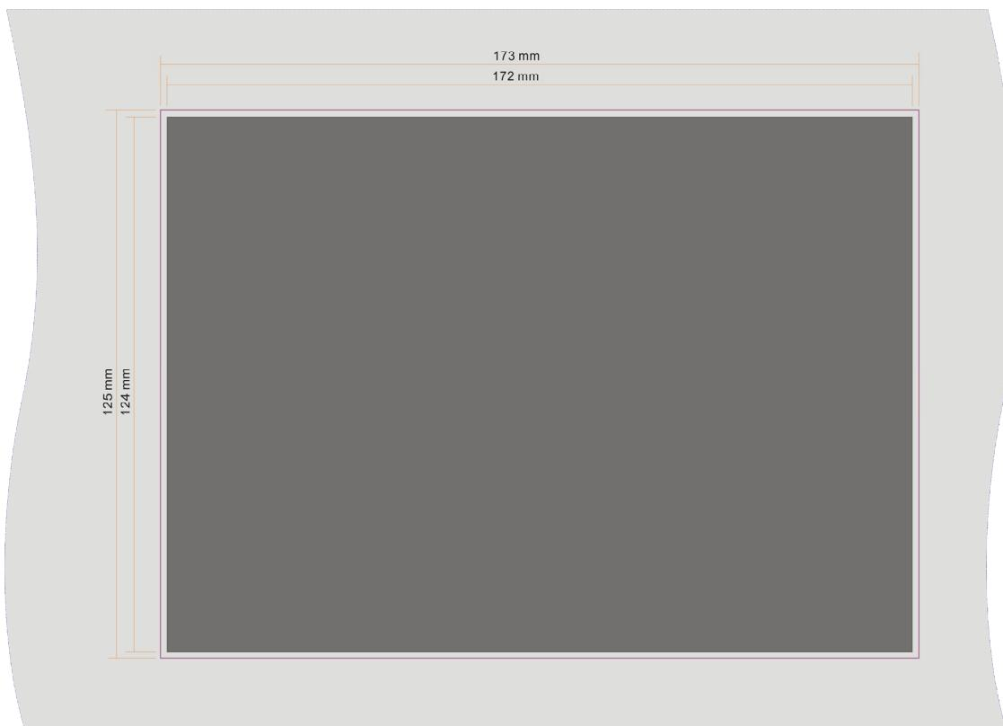
开孔尺寸: 173mm\*125mm (宽\*高), 虚线框为控制器尺寸。
