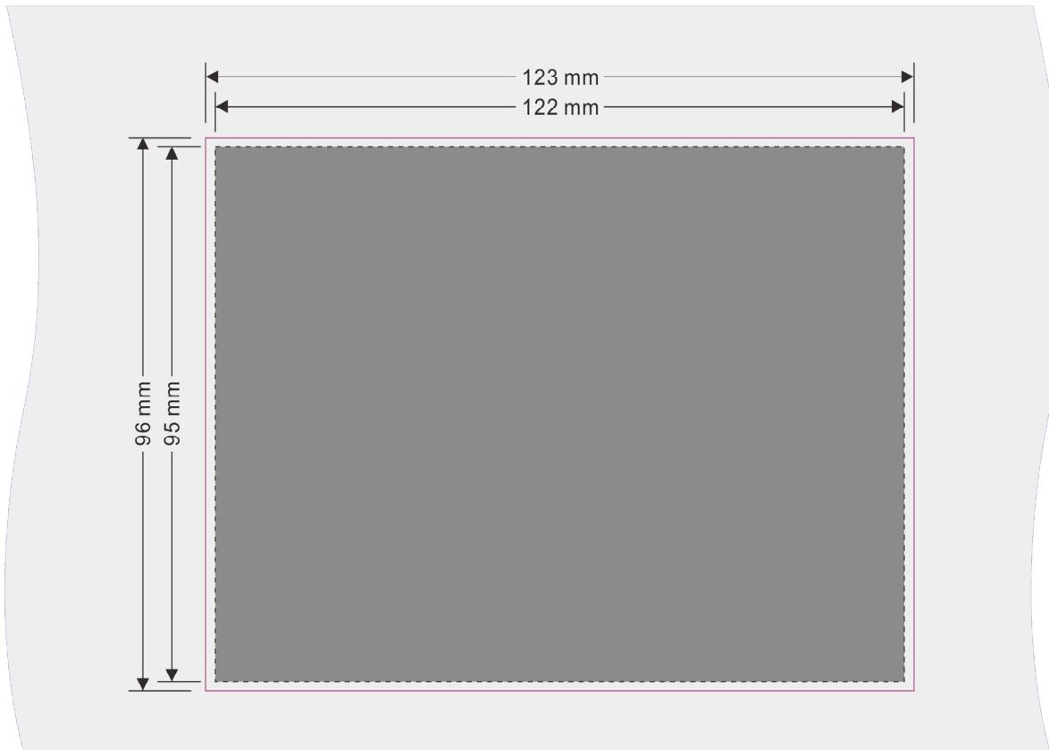
开孔尺寸: 123mm\*96mm (宽\*高), 虚线框为控制器尺寸。
