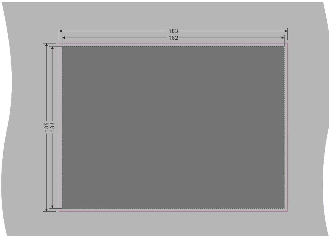
开孔尺寸: 183mm\*135mm (宽\*高), 虚线框为控制器尺寸。
