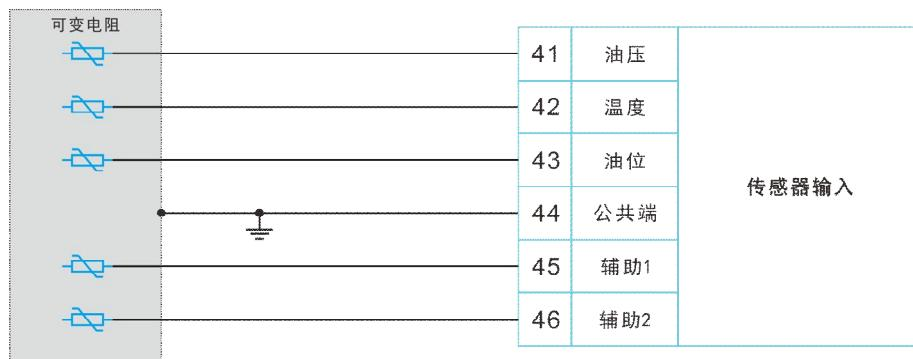
单极/两极传感器的连线:
